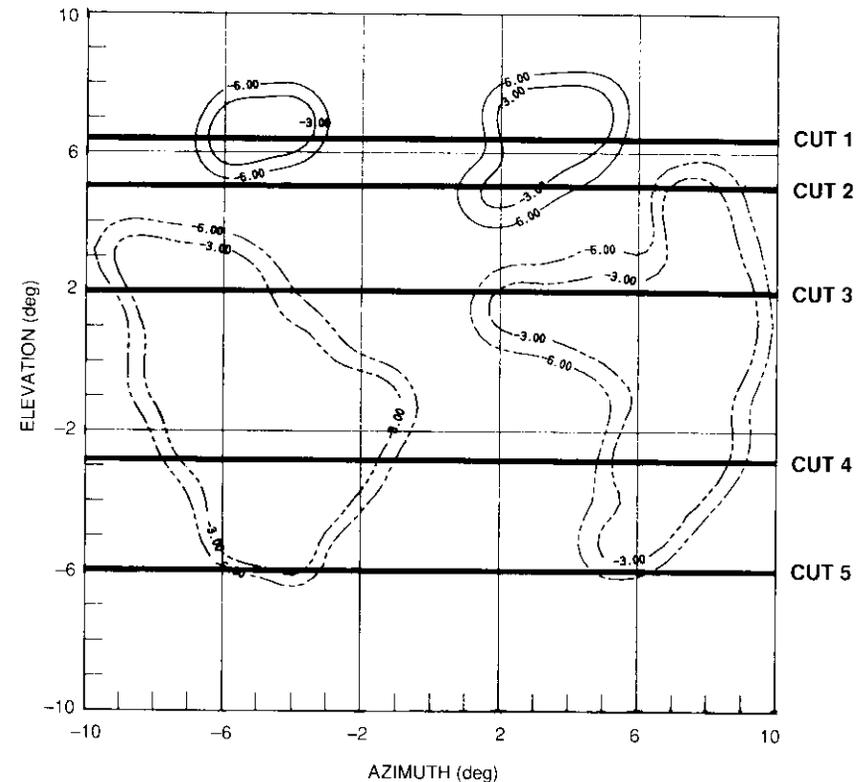
Figure 28. *INTELSAT VI Zone Beams*
