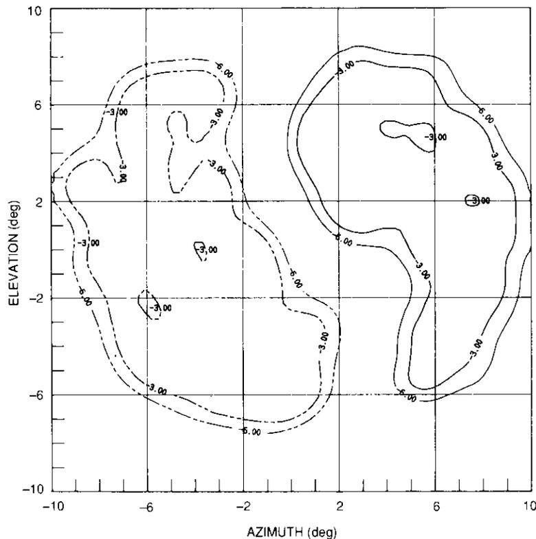
Figure 27. *INTELSAT VI Hemi Beams*
